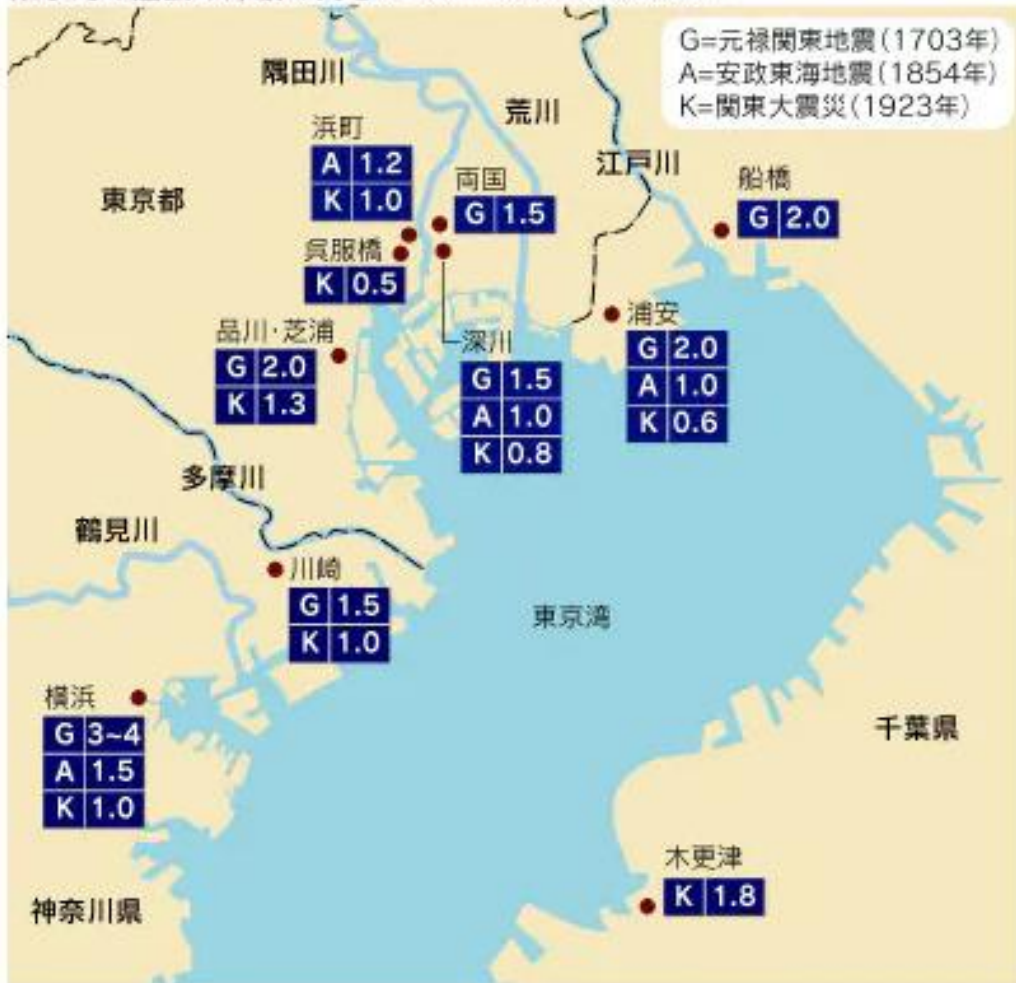
東京湾の過去の津波の高さ(単位:メートル,羽鳥徳太郎氏作成)
