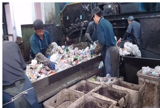
廃棄物を作業員が瞬時に手作業で振り分けます
