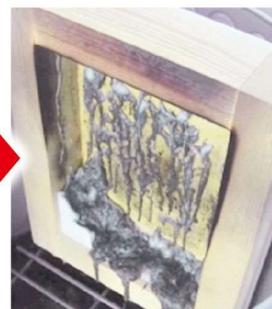
他プラスチックは炎(熱源)が存在する場合に熱分解による溶融や収縮により燃焼が継続する。
