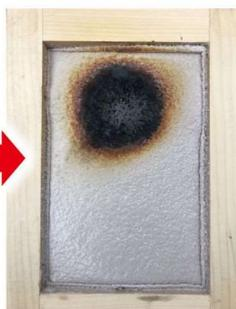
アクアモエンは燃焼時に迅速な表面炭化層(バリア層)の形成、高断熱化、可燃成分の希釈・捕捉により炎がフォーム内部に侵入しにくい。
